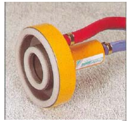
Célula de doble cámara de vacío con anillos de sellado
